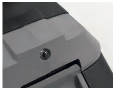
Светодиод подсветки расположен в нижней части корпуса (над аккумуляторной батареей)
