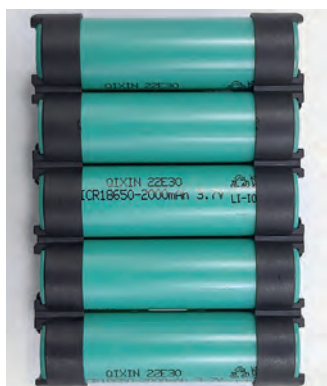
Архитектура платы для пяти элементов. Аккумулятор может заряжаться двояко через разные контакты. Внутри установлены элементы QIXIN ICR18650-2000 mAh. Надёжная и аккуратная точечная сварка элементов на четыре точки
