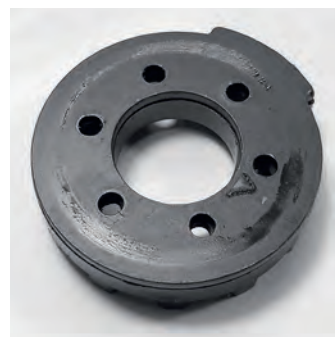
Муфта фиксации дополнительной оснастки отделена от корпуса редуктора. С обратной стороны имеется стальная промежуточная пластина
