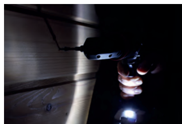
Работа светодиодной подсветки, с насадками и без. Светит ярко и правильно – вперёд и вверх, то есть точно на битку или сверло
