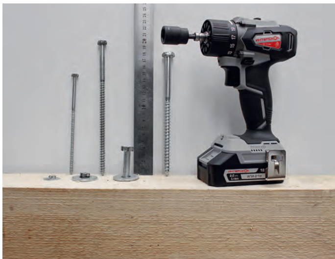
Тест на усилие закручивания больших «глухарей» размером 6×150, 8×200 и 10×180 мм
