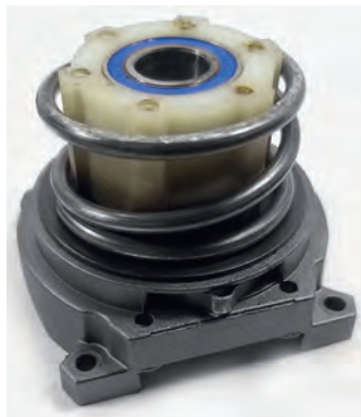
Муфта фиксации дополнительной оснастки отделена от корпуса редуктора. С обратной стороны имеется стальная промежуточная пластина
